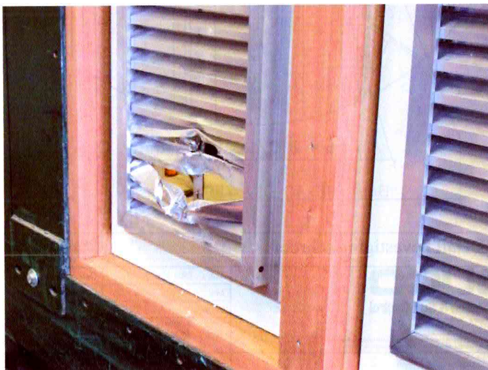
Foto 2: Beeld van type B na voorbeproeving op RVS versterkingsstrip.
