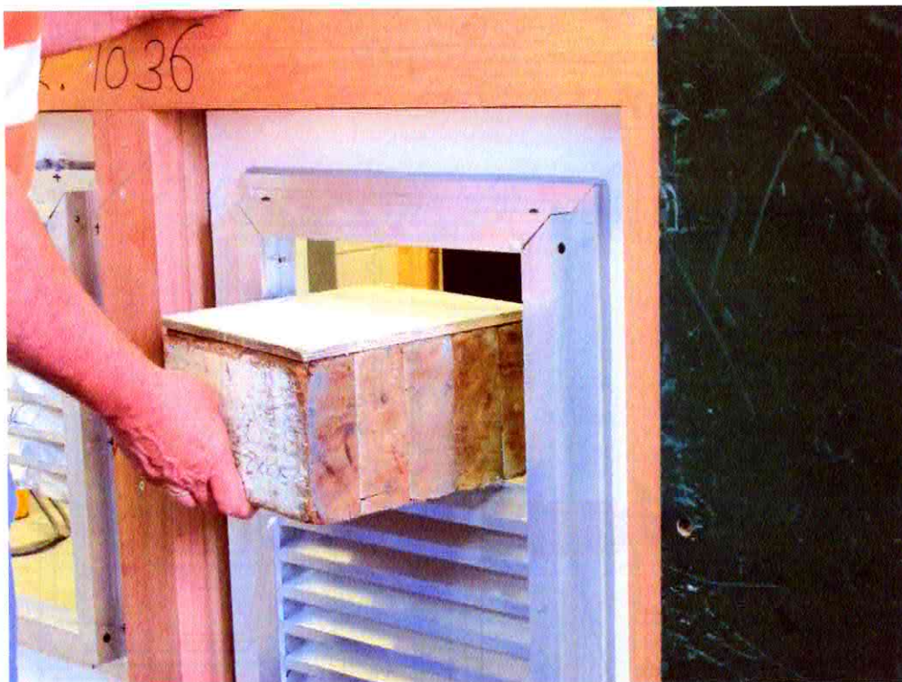
Foto 1: Doorgang tijdens voorbeproeving bij Type A zonder RVS versterkingstrip
