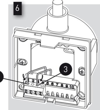
6 Introduisez les câbles secteur dans les bornes de la platine murale (**le conducteur + dans le poste de serrage 1 et le conducteur - dans le poste 3**).
