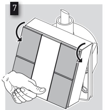
7 Clipsez le boîtier sur la platine murale. Rétablissez l'alimentation secteur. Le système est à présent prêt à fonctionner.
