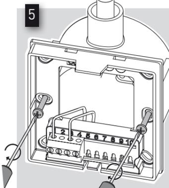
5 Vissez la platine murale au mur. (Les vis sont livrées en standard.)
