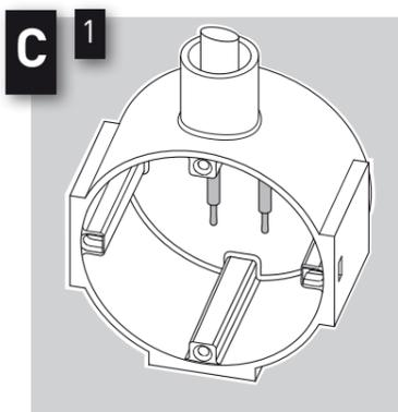
1 Installez un socle de prise de courant complet avec câblage à l'endroit voulu. Lors de l'installation, veillez à prévoir une profondeur minimum de **45 mm**.
