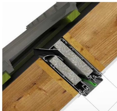
Profondeur d'encastrement 115 mm
