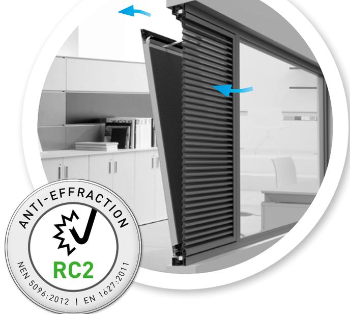
La DucoGrille NightVent est un volet de ventilation intégré en feuillure (pour des épaisseurs de verre de 24 à 48 mm) qui assure un refroidissement et une ventilation efficaces de tout bâtiment grâce à l'entrée d'un **grand** débit d'air (369 l/s\*m<sup>2</sup> à une différence de pression de 2 Pa).
