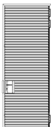
Einfache Tür nach außen drehend
