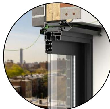
Speziell für das Vereinigte Königreich wurde eine Variante auf die geltenden Vorschriften zugeschnitten: der **SkyVent UK**. Hier ist die innere Lüftungsplatte auf eine äquivalente Fläche von 5000, 7500 oder 10000 mm<sup>2</sup> begrenzt. Diese Variante ist immer als schalldämmende AK-Version ausgeführt.
