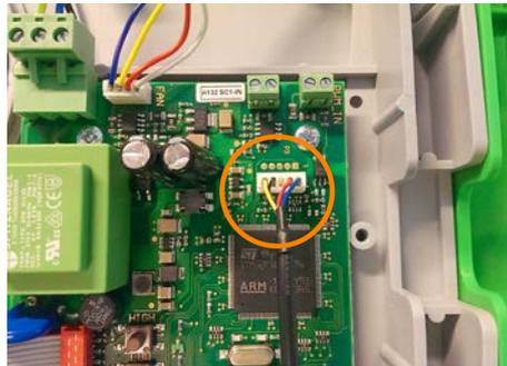
Figure 2. Raccordement au DucoBox Silent / Focus
