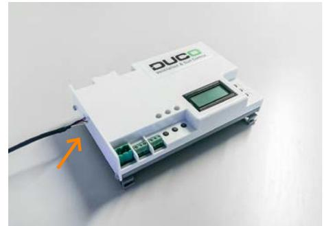
Figure 1. Raccordement à l'Unité IQ
