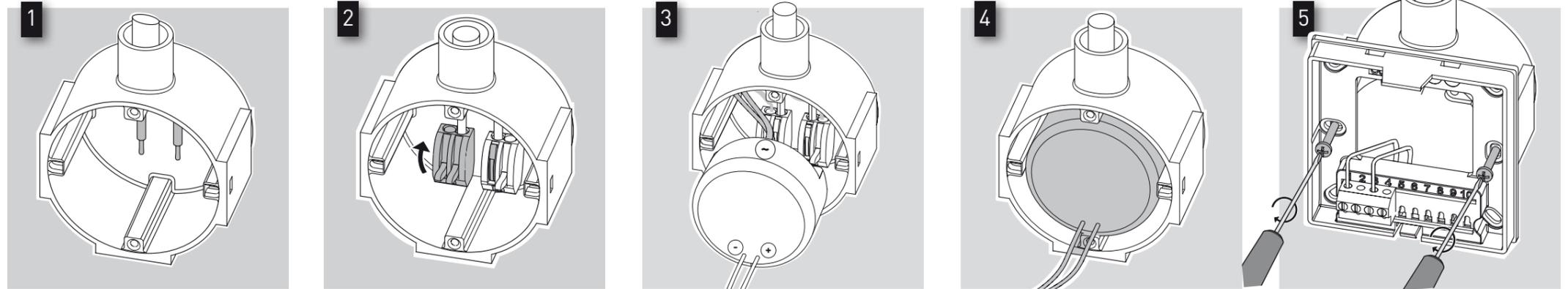
**1** Installez un blochet de prise de courant complet avec câblage à l'endroit voulu. Lors de l'installation, veillez à prévoir une profondeur minimum de **45 mm**.
