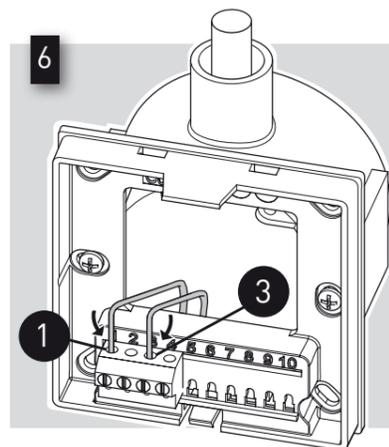
**6** Enfichez et vissez les câbles secteur dans les bornes de raccordement de la platine murale (**le conducteur + dans la borne de serrage 1 et le conducteur - dans la borne 3**).
