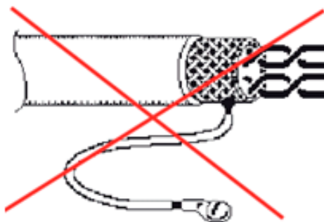
Mauvais raccordement du blindage
