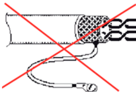
Verkeerde aansluiting afscherming
