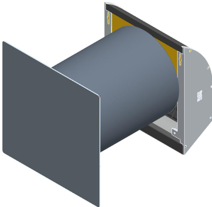
1. Le manchon en PVC est poussé, avec la mousse, dans le trou percé d'un Ø de 250 mm via l'extérieur du mur. Il est important que le manchon soit au même niveau que l'intérieur du mur intérieur. La longueur du manchon ne peut dépasser celle de l'épaisseur totale du mur. Le manchon doit être placé de manière à ce que les côtés intérieur et extérieur puissent être jointoyés.
