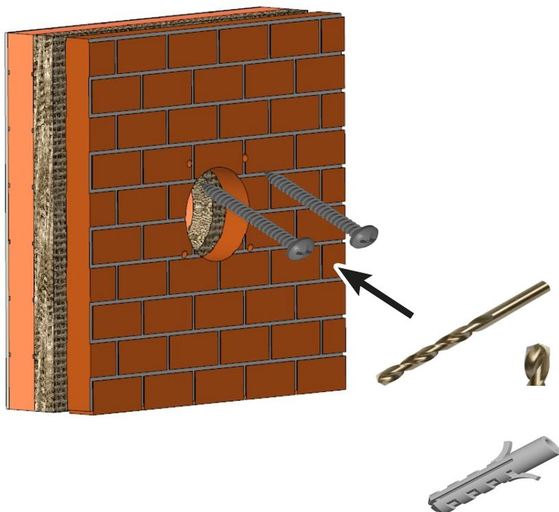
4. Positionnez le Silenzio ZR en plaçant l'ouverture située dans les fentes supérieures sur les vis.
