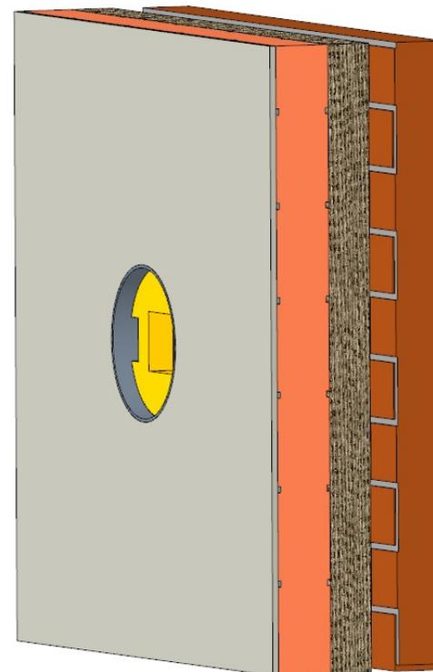
1. Placez la plaque d'aluminium pliée, avec les paliers lisses déjà montés, dans le manchon en PVC. Placez la plaque horizontalement et dessinez les 6 trous. Retirez la plaque et percez les 6 trous d'un diamètre 6 mm. Insérez les chevilles 3x30 fournies dans les trous percés.
