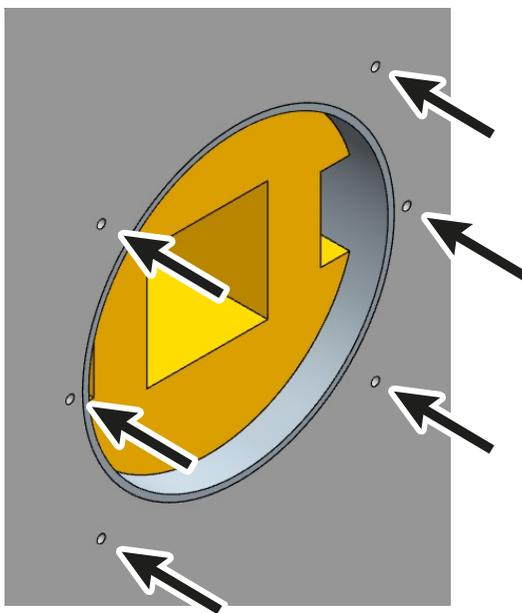
2. Remplacez la plaque dans le manchon et vissez ce dernier à l'aide des vis fournies 4x38mm.
