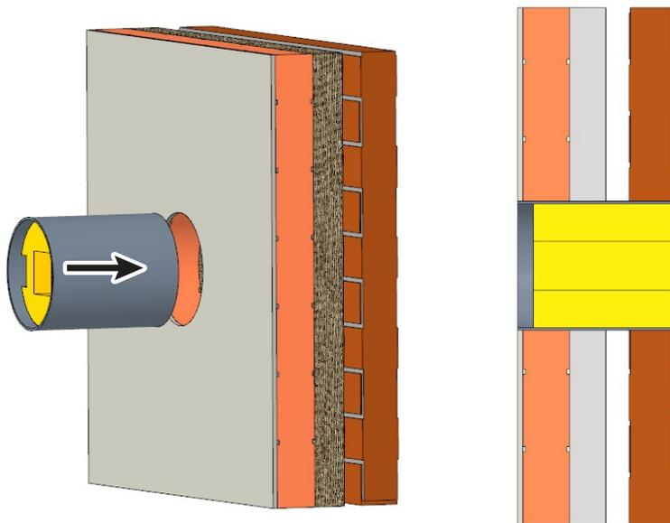
2. Placez le manchon en PVC comme sur l'illustration. Le carré dans la mousse doit être d'aplomb avec les deux espaces à gauche et à droite.
