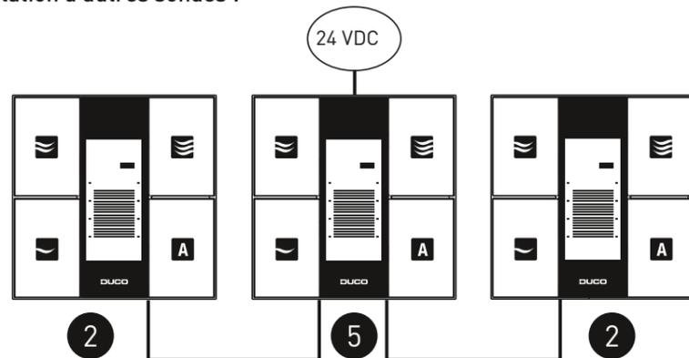
Installer une prise de courant murale de diamètre minimal de 60 mm et de profondeur minimale de 50 mm. Un câble trifilaire de 3 x 1,5 mm aboutit à un transformateur. Un câble de 2 x 0,75 mm repart pour assurer l'alimentation en 24V= du composant placé en aval.
