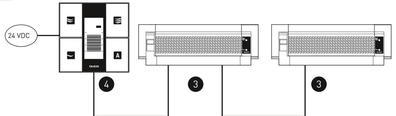
Installer une prise de courant murale de diamètre minimal de 60 mm et de profondeur minimale de 50 mm. Tirer un deuxième câble bifilaire de 2x0,75 mm pour l'alimentation en 24V= de la sonde. Un même câble part pour assurer l'alimentation du composant en aval.
