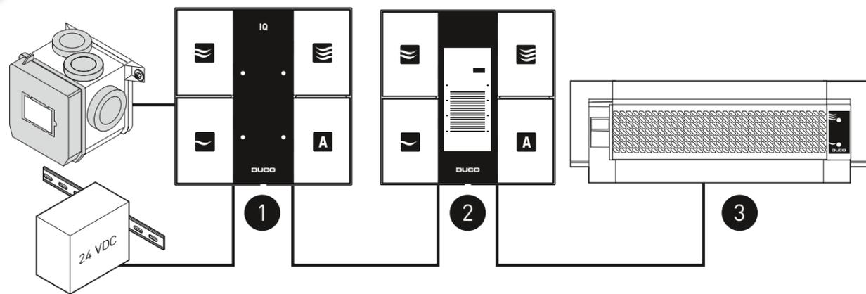
Installer une prise de courant murale de diamètre minimal de 60 mm et de profondeur minimale de 50 mm. Tirer un câble bifilaire de 2x0,75 mm partant d'une alimentation rail DIN jusqu'à la prise de courant murale pour alimenter le dispositif IQ en 24V=. Un même câble part pour assurer l'alimentation du composant en aval. Prévoir à côté une prise secteur 230Vca pour l'alimentation du caisson d'extraction. La liaison entre le caisson CV et le dispositif IQ doit être effectuée au plus court.
