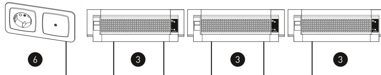
Installer une prise de courant murale de diamètre minimal de 60 mm et de profondeur minimale de 50 mm. Un câble trifilaire de 3 x 1,5 mm aboutit à un transformateur. Un câble bifilaire de 2 x 0,75 mm part de la prise de courant murale pour assurer l'alimentation du composant en aval ou en amont.
