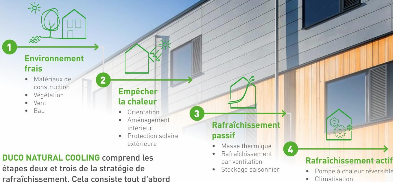
**DUCO NATURAL COOLING** comprend les étapes deux et trois de la stratégie de rafraîchissement. Cela consiste tout d'abord à empêcher la chaleur d'entrer à l'aide d'un système de protection solaire extérieure, conformément au principe norme **Zero Energy**.
