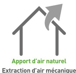
Le caisson d'extraction met la maison en dépression (aspiration dans les pièces humides), pour que l'air rentre par les entrées d'air dans les pièces sèches
