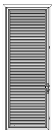
Porte simple s'ouvrant vers l'intérieur
