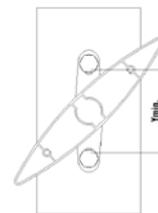
Situation 1 : Montage de la lame entre deux platines de fixation fabriquées sur mesure.
