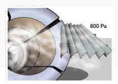
La résistance des systèmes de brise-soleil externes peut être déterminée de manière optimale à l'aide de tests en soufflerie, où des flux d'air maximaux sont générés. DUCO teste ses systèmes de brise-soleil à l'Institut Von Karman à Bruxelles, un institut indépendant de premier plan à l'échelle internationale en matière de recherche de pointe sur la dynamique des flux.
