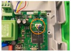
Figure 2. Raccordement au DucoBox Silent / Focus
