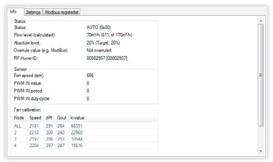
Figure 10. Onglet Informations d'un DucoBox Focus
