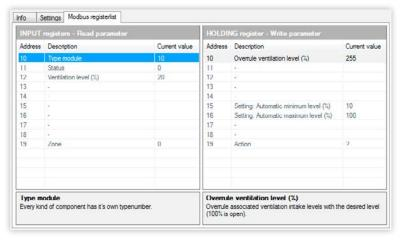
Figure 12. Liste des registres ModBus d'une Commande à distance
