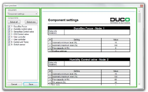
Figure 13. Paramètres des composants
