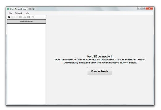
Si aucune connexion USB n'a été établie au démarrage, vous vous retrouvez dans le mode hors ligne de l'application. Le câble USB peut encore être raccordé à un composant Duco Master (DucoBox ou Unité IQ). Il est recommandé de cliquer ensuite sur "Scan network" pour pouvoir récupérer la synthèse du réseau (comme lors du démarrage avec connexion USB). Une fois ces étapes exécutées, l'application passe automatiquement à cette synthèse (voir le chapitre 2.1.3 à la page 8).
