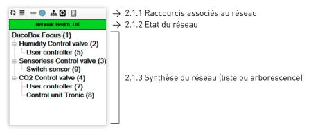
Figure 5. Synthèse du réseau avec un message d'erreur
