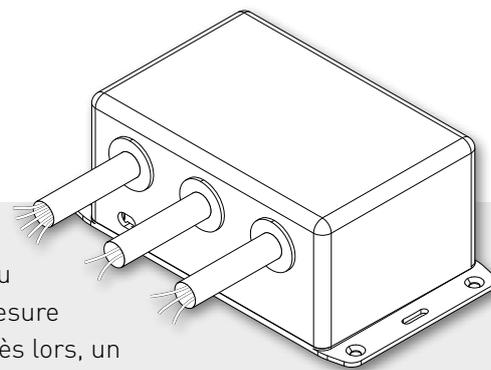
La Commande d'actionneur peut ajouter divers composants au réseau Duco (protocole DucoBus) et les commander selon les données de mesure (par ex. valeurs de CO<sub>2</sub> ou d'humidité relative) au sein de ce réseau. Dès lors, un clapet VAV externe peut être commandé selon la concentration de CO<sub>2</sub>, comme un volet d'arrivée ou d'évacuation externe pour une ventilation de refroidissement.
