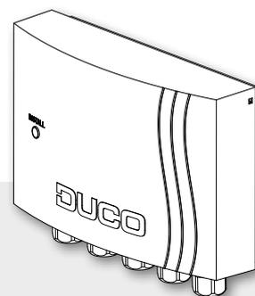
La DucoBox Eco Boiler Control est un module de commande qui permet à la pompe à chaleur de ventilation DucoBox Eco de produire un maximum de chaleur. Lorsque des températures trop basses sont enregistrées dans le tampon, le Boiler Control active les résistances électriques pour chauffer le tampon.
