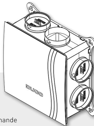
La DucoBox Focus est une unité d'aspiration compacte, durable et extrêmement peu énergivore, **équipée d'un système de clapets de régulation** intégré fonctionnant sur la base de mesures de CO<sub>2</sub> et d'humidité, spécialement conçue pour une application dans des systèmes de ventilation naturelle à la demande de Duco, et évacue l'air humide et/ou vicié par zone, quand cela s'avère nécessaire et en quantité adaptée.
