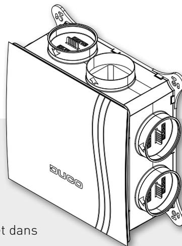
La DucoBox Focus est une **unité d'extraction** compacte, durable et extrêmement économe en énergie avec un système de clapets de réglage intégré basé sur les mesures de CO<sub>2</sub> et d'humidité. Elle a été développée pour être utilisée dans les systèmes de ventilation à demande contrôlée de DUCO et extrait de manière zonale l'air humide et/ou pollué lorsque cela est nécessaire et dans la bonne quantité.
