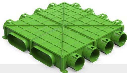
Le caisson de distribution 2 x ovale (sol) fait la connexion entre maximum 12 conduits DucoFlex D63 et 2 x DucoFlex ovale. Cela permet de positionner le caisson de manière plus accessible. Grâce au principe intelligent "Click & Go", les conduits DucoFlex peuvent être raccordés rapidement et de manière parfaitement étanche.
