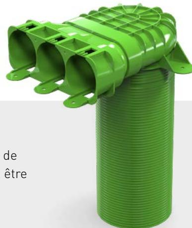
L'adaptateur coudé fait la connexion entre maximum 3 conduits DucoFlex D63 et la bouche d'extraction D125. L'accouplement long convient à tout type de sol. Grâce au principe intelligent "Click & Go", les conduits DucoFlex peuvent être raccordés rapidement et de manière parfaitement étanche.
