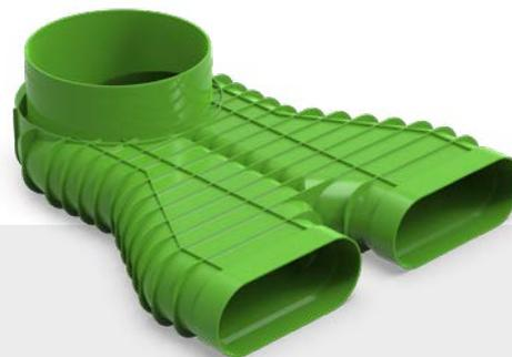
Le raccordement pour conduit ascendant est un élément multifonctionnel. Il fait la connexion entre 2 x DucoFlex ovale et une colonne montante D160. En combinaison avec les adaptateurs 3x63, le raccordement peut être utilisé comme caisson de distribution avec un maximum de 6 raccords D63.
