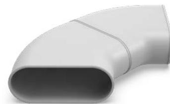
Dans la version standard, le coude horizontal permet de réaliser un coude à 90° dans un conduit ovale rigide. La pièce peut facilement être découpée pour obtenir un coude à 45°.
