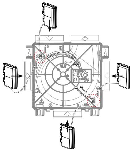
**nl** Figuur 5: vier mogelijkheden voor bekabeling van maximaal één CO<sub>2</sub> Boxesensor naar printplaat
