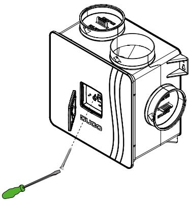
**nl** Figuur 1: verwijder het afdekplaatje en schroef het deksel los
