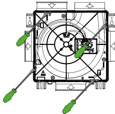
**nl** Figuur 2: motorplaat losmaken
