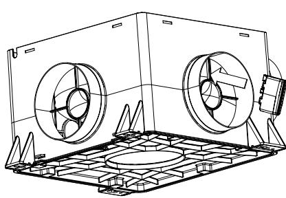
**nl** Figuur 4: CO<sub>2</sub> Boxesensor in aansluitmond vastklikken
