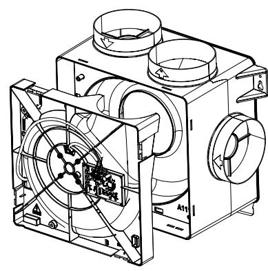
**nl** Figuur 3: motorplaat verwijderen
