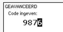
Au bout de 30 minutes d'inactivité ou après le redémarrage de la DucoBox Eco, le menu avancé est refermé. Il est également possible de verrouiller manuellement le mode avancé à l'aide de la commande **FERMER AVANCÉ**.
