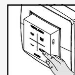
La DucoBox va maintenant effectuer une calibration en fonctionnant temporairement à haut régime. Cela peut prendre jusqu'à 1,5 minute. L'équilibrage est terminé lorsque la DucoBox ralentit, que les LED du bouton **< AUTO >** des Commandes à distance / Capteurs muraux deviennent blanches et que la LED de la DucoBox devient blanche.
