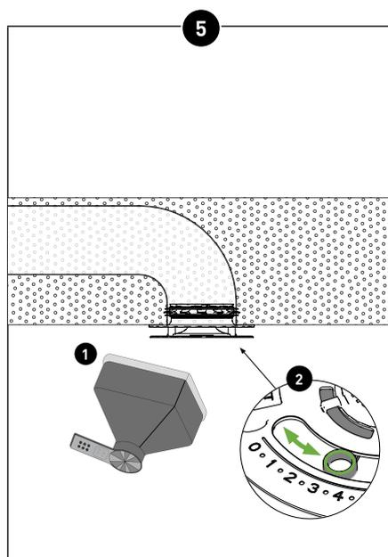
Contrôle des débits et réglage fin
