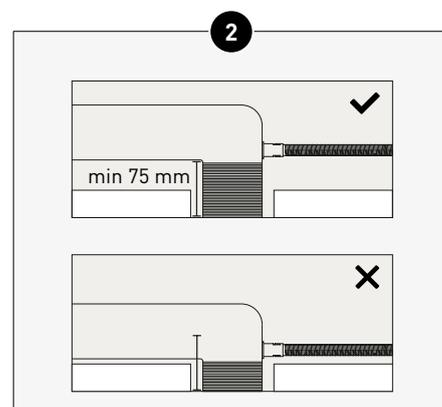
La profondeur d'installation doit être d'au moins 75 mm pour pouvoir monter la bouche.
