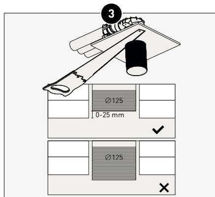
Le bas de l'adaptateur doit se trouver à 0 à 25 mm au-dessus de la couche de finition. Coupez la longueur supplémentaire.
