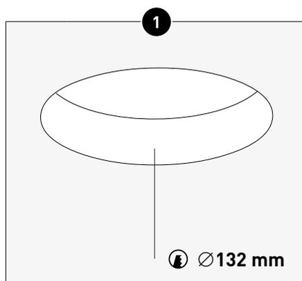
Découper une ouverture dans la plaque de plâtre à l'endroit souhaité. Veillez à ce que la surface soit plane et lisse.
